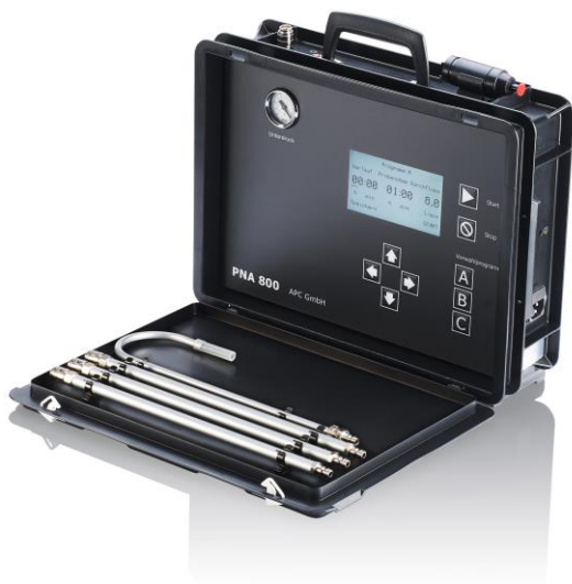
Probenahmegerät PNA 800, Frontseite offen (im Batteriebetrieb)
